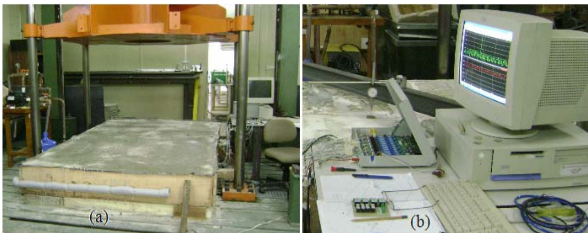
Figura 2 – Placa de concreto. (a) placa instrumentada, (b) Disposição do sistema de gerenciamento e aquisição de sinais.
