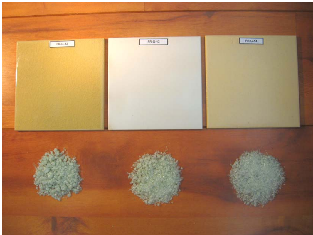
Figura 1: Fritas FR-G -12/13/14 obtidas e revestimentos 15X15 cm com aplicação de vidrados obtidos das respectivas fritas
