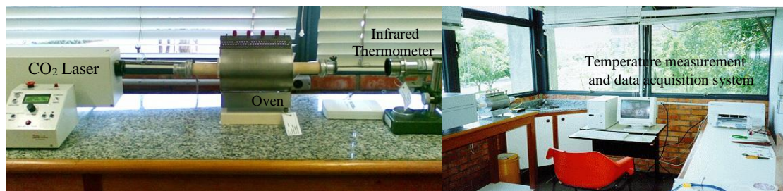
Figure 4. In house made bench for the thermophysical properties measurements. LMPT – Laboratório de Medição de Propriedades Termofísicas de Combustíveis Nucleares e Materiais.
