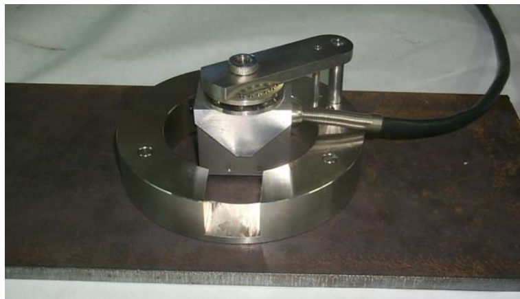
Figura 3 - Montagem para a verificação da dependência direcional do ruído magnético Barkhausen.
