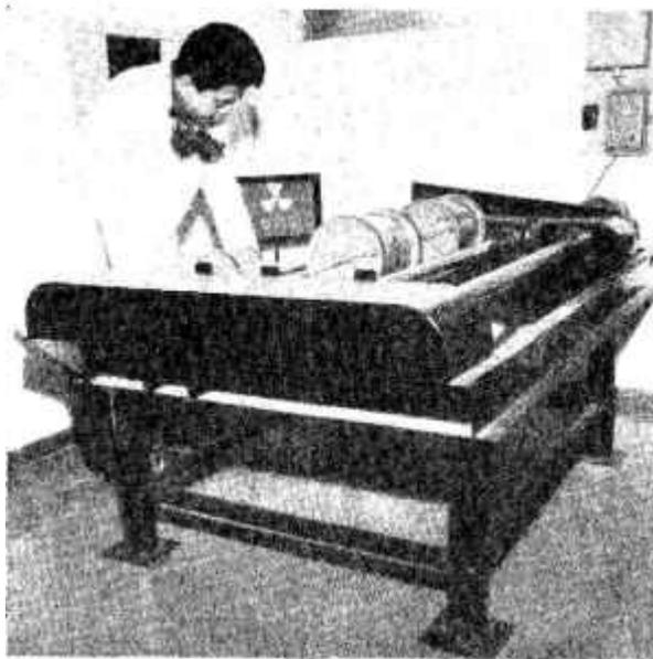
Fig. 2 — Condicionamento das cargas de  $U_3O_8$  enriquecido e alumínio em recipientes cilíndricos de 3 dm<sup>3</sup> de volume útil de material plástico, com esferas de borracha dura.
