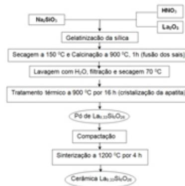
Figura 2 – Fluxograma do processo de síntese
