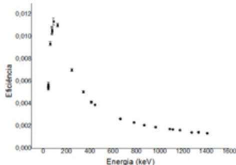
Figura 1: Curva de eficiência obtida para o detector HPGe em função da energia gama. Distância fonte-detector: 100 mm
