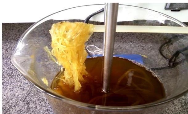
Figura 1 – Fibras após o ataque alcalino
