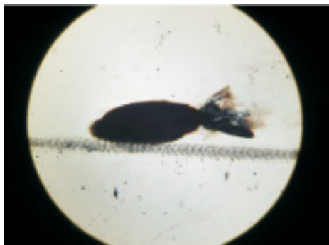
Figura 4: placa de Si, zona afetada pelo laser "gravata"
