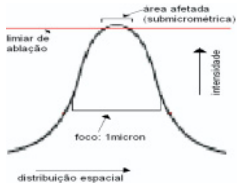
Figura 1: Possibilidade de usinagem abaixo do limite de focalização (precisão submicrométrica)
