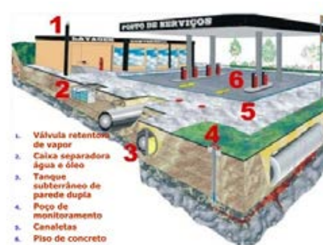
Figura 2. Equipamentos e sistemas de um posto de abastecimento de combustível. Adequação ambiental dos postos de revenda de combustíveis.
