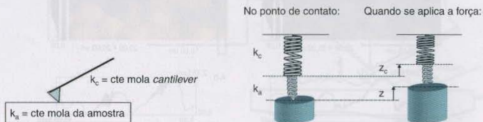
FIGURA 13.10 Diagrama esquemático de cantilever e amostra (A) e sistema massa-mola equivalente (B).
