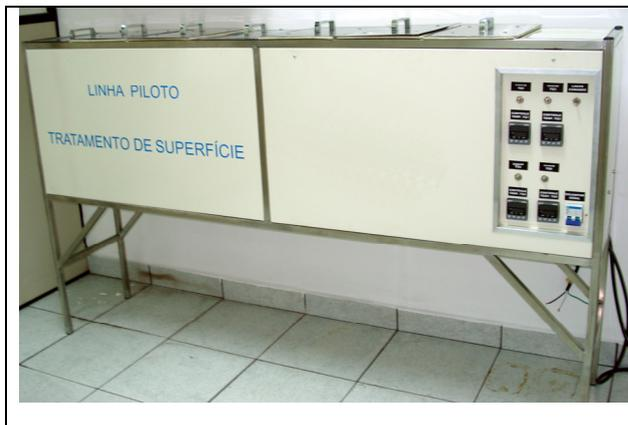
Figura 1. Linha de fosfatização industrial desenvolvida em parceria com a BASS Equipamentos Ltda.
