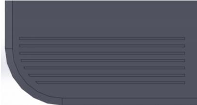
Figura 1 - Imagem ilustrativa da superfície de saída de ferramenta cerâmica texturizada
