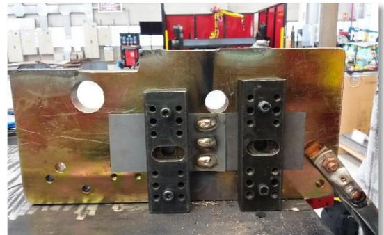
Preparação de corpos de prova para ensaio de tração em máquina de ensaios universal Instron.
