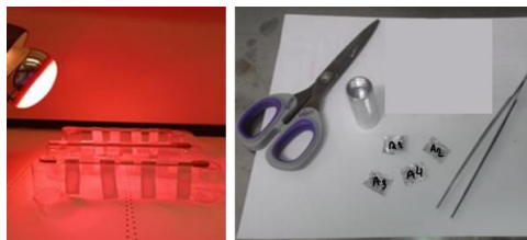
Figura 1. Preparo das soluções de Th-228 pipetadas e irradiação.
