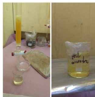
Figura 2. Cromatografia com resina de troca aniônica e amostra purificada.
